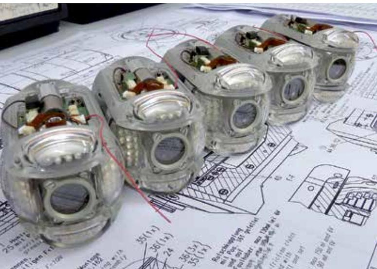
Bild 2: Der kompakte Kamerakopf ORION wird über drei Kleinstantriebe bewegt.
